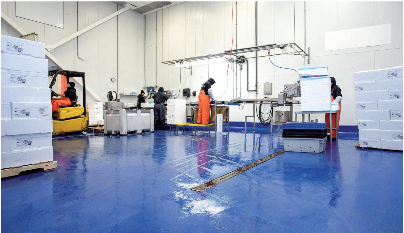
**Pavimentazione Flowfresh dei locali di produzione dell'americana "Boston – Sword & Tuna". Questo tipo di pavimentazione garantisce una superficie antimicrobica, confortevole ed ecologica, facilmente sanificabile, con riduzione del 99% della crescita batterica o delle muffe.**
