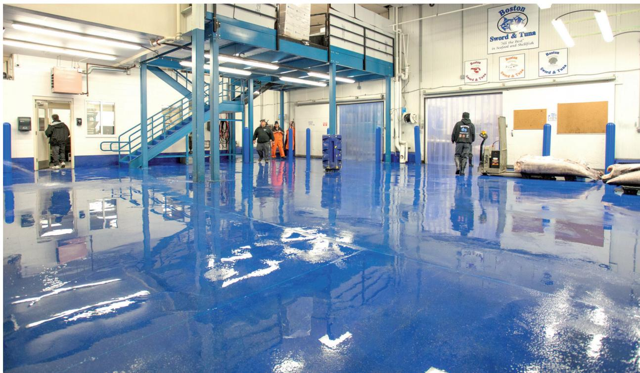
Lo studio e la progettazione di una pescheria e, più in generale, dei locali destinati alla produzione del comparto alimentare richiede di ridurre al minimo i rischi di contaminazione biologica. La scelta di un rivestimento resinoso appropriato mantiene alto il livello di igiene di chi lavora e della qualità del prodotto. In foto, le pavimentazioni realizzate con la linea in poliuretano cemento Flowfresh in uno stabilimento di lavorazione del pesce.
