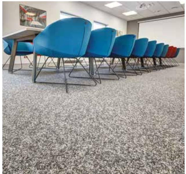
Le liant en résine a pour fonction d'enrober et d'agglomérer les granulats minéraux, pour constituer un revêtement souple, continu et sans joints. La résine apporte notamment à la moquette de pierre sa résistance aux intempéries, aux UV, ainsi qu'à l'eau chlorée des piscines.
