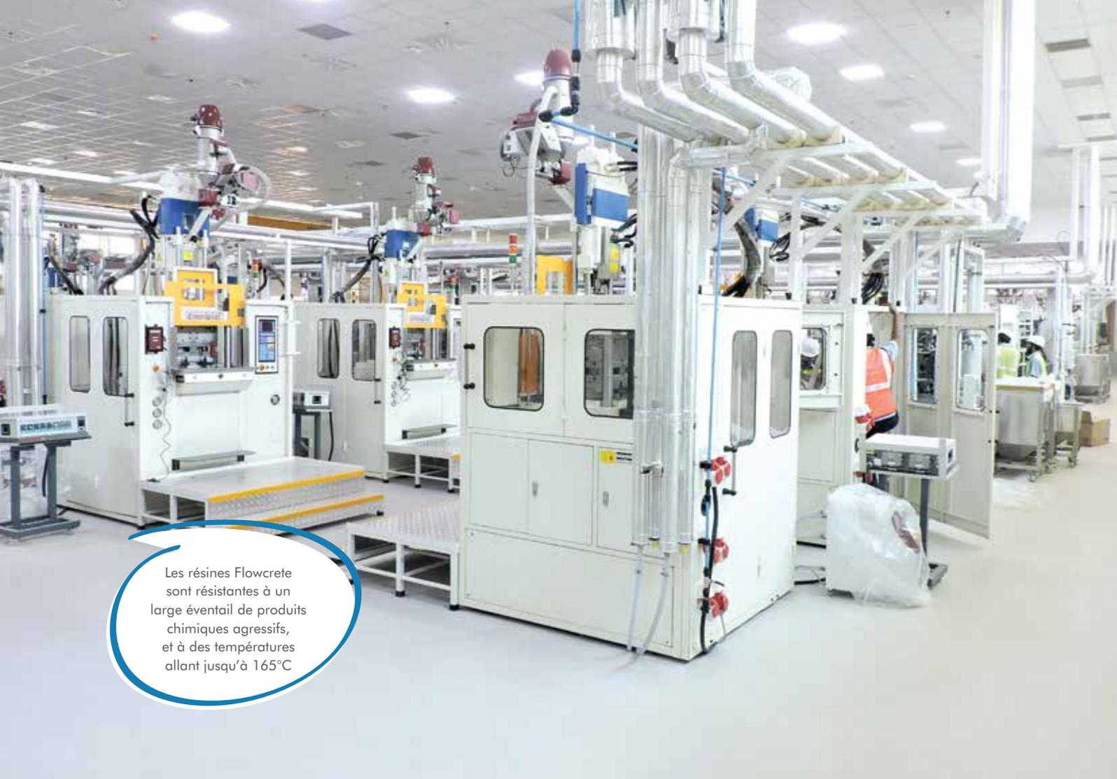
Les résines Flowcrete sont résistantes à un large éventail de produits chimiques agressifs, et à des températures allant jusqu'à 165°C
